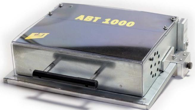
CSTの新しいABTヒートチャンバーボックスシステムは、最大80℃までのメモリモジュールのテストに、ユニークかつ費用対効果の高いアプローチを提供します。このコンパクトなシステムは「ベンチトップ」用途に最適で、ハロゲンランプ技術による迅速な温度上昇と、加熱および冷却時の精密な温度制御が可能な統合型熱ヒーターボックスを搭載しています。
